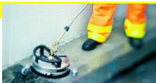
Kärcher oppervlaktereiniger Met roterende powersproeierbalken voor 10 maal sterkere oppervlakteprestatie
